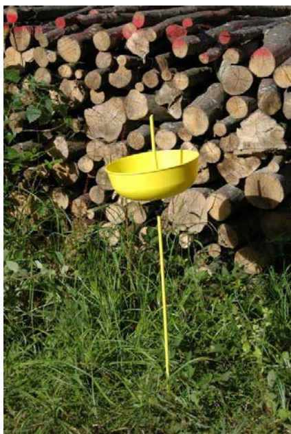
Photo 4 : Exemple de piège coloré : un bac jaune sur son support.
